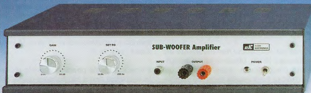
Fig.1 L'amplificatore Sub-Woofers che vi proponiamo in queste pagine va racchiuso dentro un mobile metallico completo di mascherina in alluminio forata e serigrafata.
