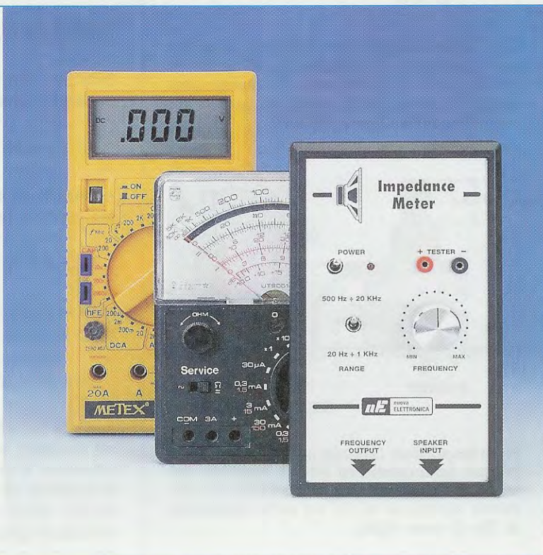
Fig.3 All'uscita del nostro circuito possiamo applicare sia un Tester Digitale commutato sulla portata 200 millivolt CC che un Tester Analogico commutato sulla portata di 0,3 volt CC.
