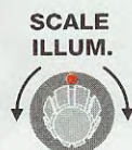
Fig.7 La manopola SCALE ILLUM. viene utilizzata solo per illuminare il "reticolo" dello schermo per meglio visualizzare la posizione occupata dal segnale.
