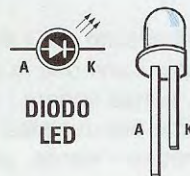
Fig.3 Ricordate che il terminale più lungo di un diodo è l'Anodo e il più corto è il Catodo.
