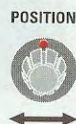
Fig.22 La manopola con la scritta POSITION (vedi in alto in fig.1) serve per spostare la traccia sullo schermo in orizzontale, cioè da destra verso sinistra o viceversa.
