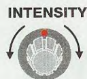
Fig.5 La manopola INTENSITY presente sotto allo schermo (vedi fig.1) serve per rendere più o meno luminosa la traccia del segnale visualizzato.
