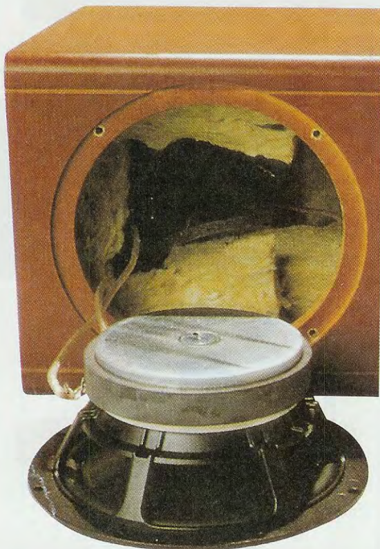
Fig.17 L'altoparlante del Sub-Woofers dovrà sempre essere racchiuso dentro una appropriata Cassa Acustica che potrete sempre trovare in un negozio Hi-Fi. In caso contrario, a pag.452-459 del 2° Volume AUDIO Handbook, troverete alcuni esempi di Casse con Woofers e Tweeters.
