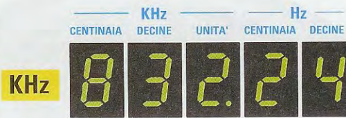
Fig.6 Se nel frequenzimetro leggerete un valore in 832,24 KHz, dovreste convertirlo in MHz dividendolo x 1.000. Per una frequenza di 0,83224 MHz il valore del condensatore risulterà di 270 pF.
